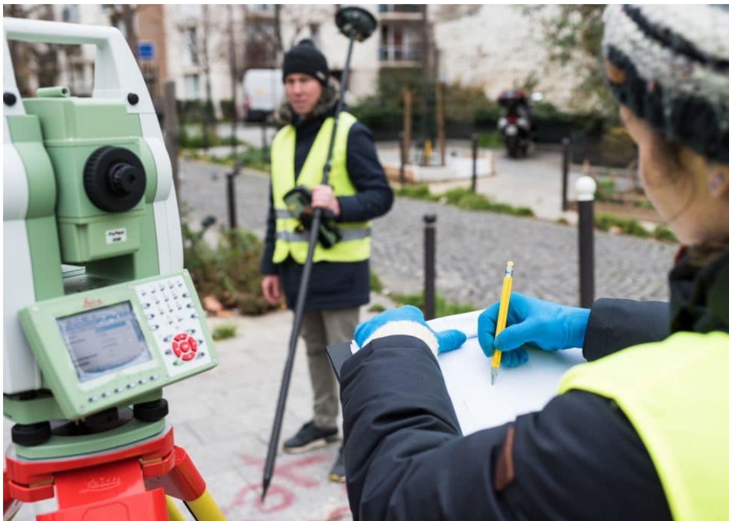
Alternants du GPI2D relevant les mesures du terrain grâce à une station totale et un GNSS et réalisant un croquis à partir des premières mesures.
