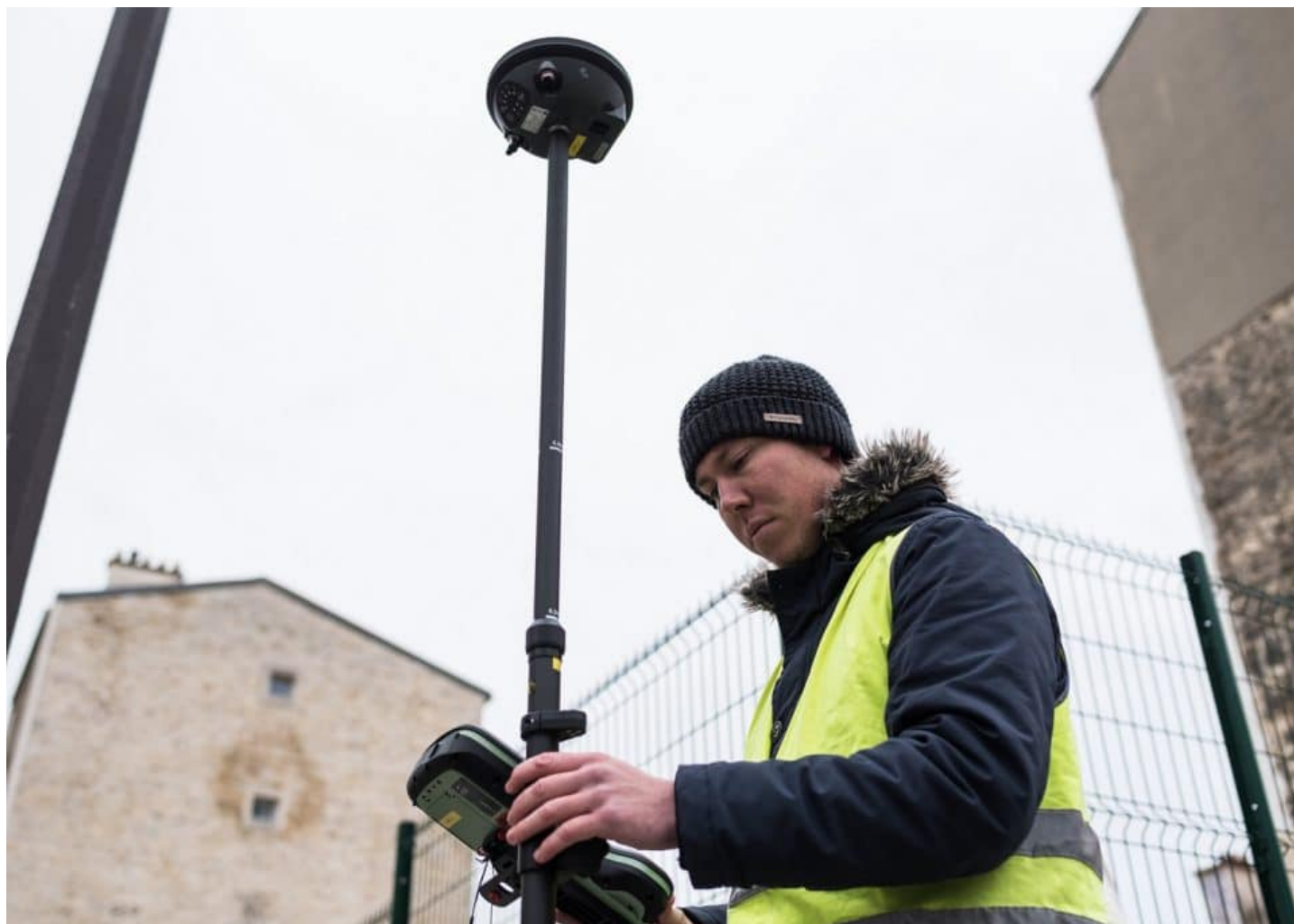
Alternant en BTS géomètre-topographe au GPI2D utilisant un GNSS sur un chantier.
