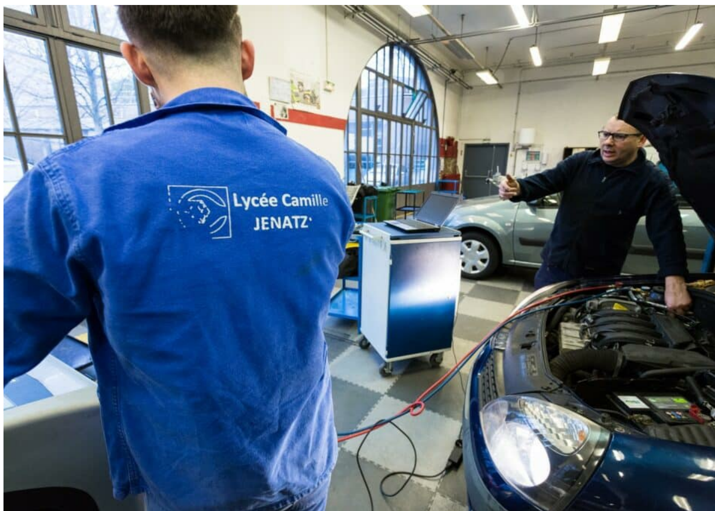
Mise en situation d'une recharge de climatisation dans l'atelier de mécanique automobile du lycée Jenatz'.
